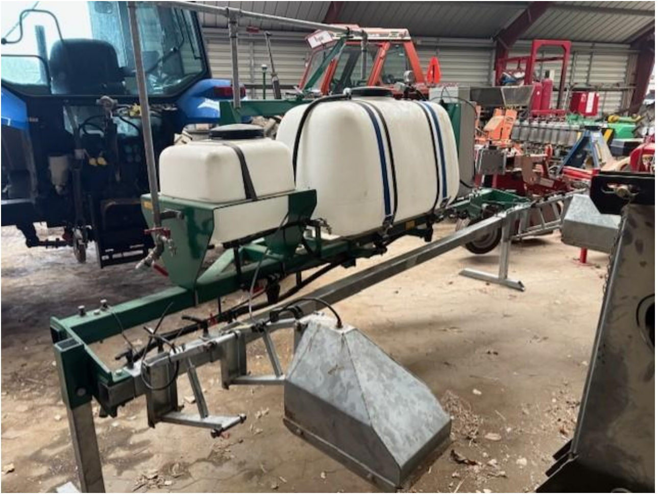
Nedvandingssprøjte til behandling med herbicider, fungicider og øvrige plantebeskyttelsesmidler, vækstregulatorer samt flydende kemisk gødning.
