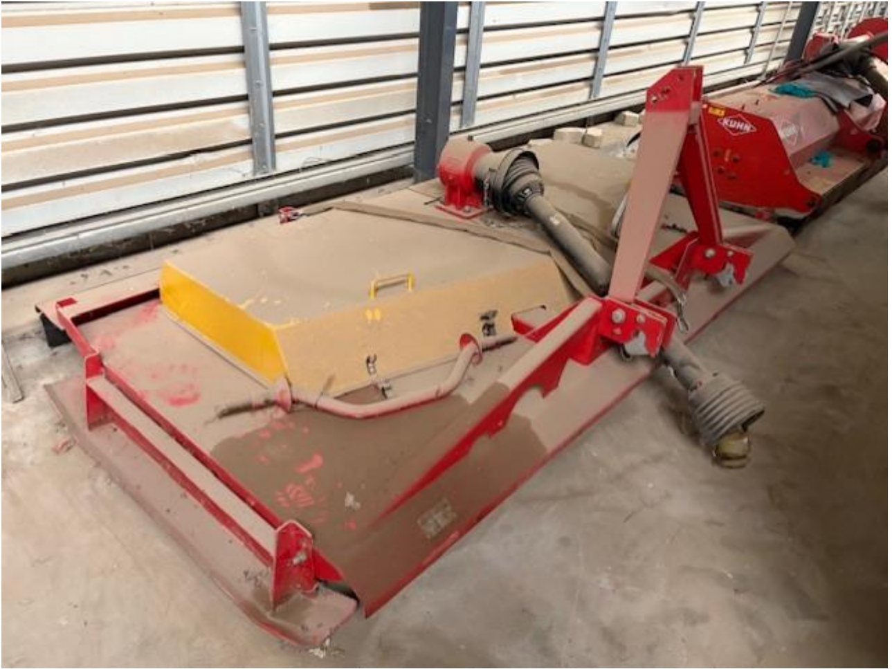
Scan agro – brakklipper til afpudsning af værnearealer og køregange
